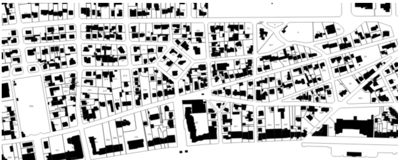
Système viaire orthogonal, L'avenue du Maréchal de Lattre de Tassigny constitue l'axe structurant qui dessert le lotissement Benoît. Les axes de desserte respectent un plan orthogonal.
