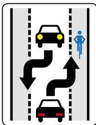
Les véhicules motorisés circulent sur une voie centrale bidirectionnelle et les cyclistes sur la partie revêtue de l'accotement appelée rive.
